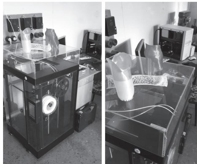
Рис. 15. 3D-принтер, обеспечивающий изготовление приёмных гильз протезов по сканированной модели культи, и образцы продукции
