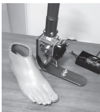
Рис. 8. Искусственная стопа со следящим приводом тыльного сгибания
